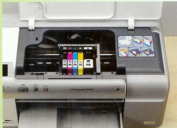
Kezdőlépés a teljes újrafelhasználáshoz: a HP D5460 nyomtatóféjének kosara mintegy 70%-ban használt nyomtatókazetták újrafeldolgozott műanyag részeiből készült.
